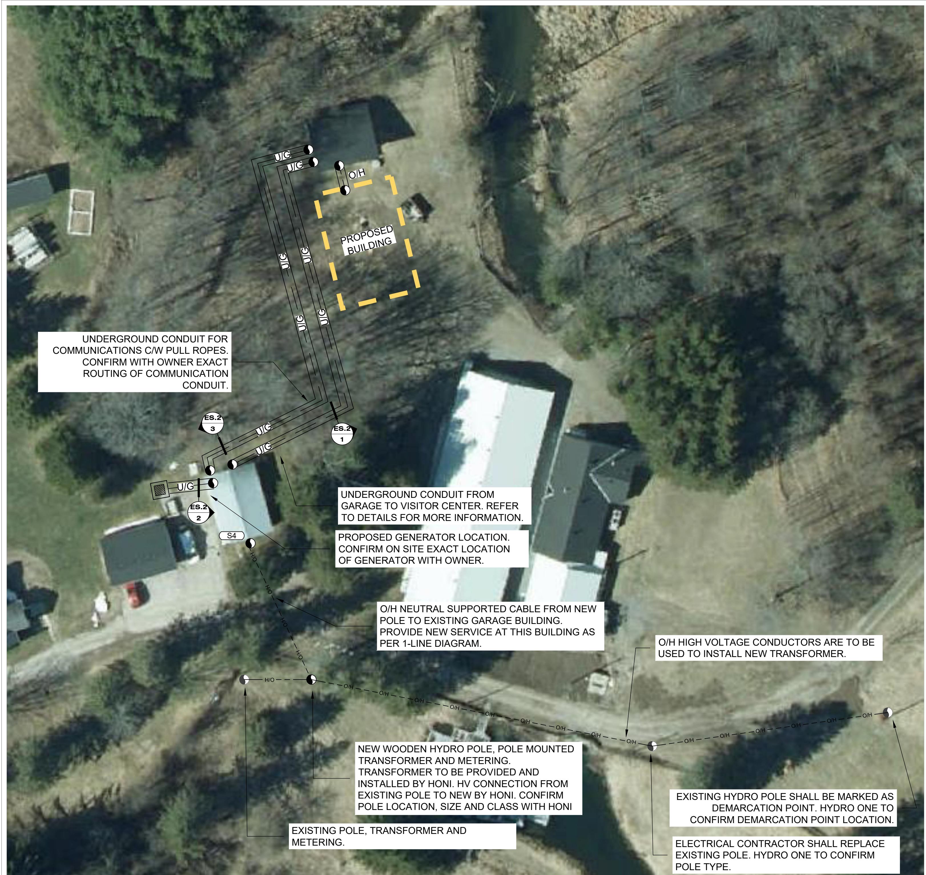
1 ELECTRICAL SITE PLAN ES.1 N.T.S
