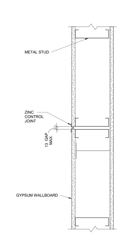
1 CONTROL JOINT PLAN DETAIL - DRYWALL
