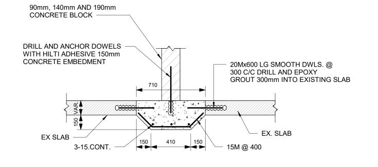
BLOCK WALL SLAB - THICKENING AT EXISTING SLAB
