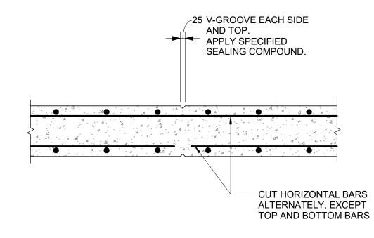
4 RETAINING WALL CONTROL JOINT
